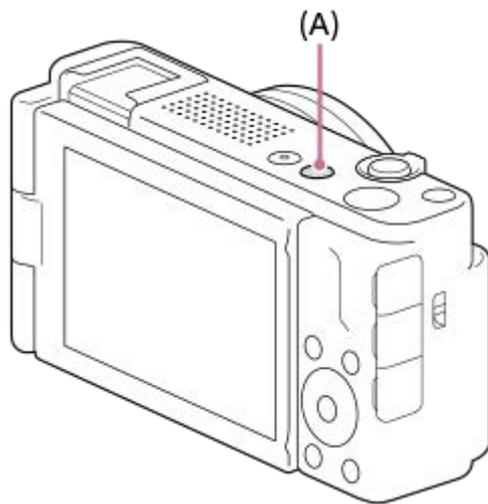
Chaque fois que vous appuyez sur le bouton Photo/Film/S&Q, le mode de prise de vue change dans l'ordre : mode de prise d'images fixes, mode d'enregistrement de films et mode d'enregistrement au ralenti/en accéléré.
