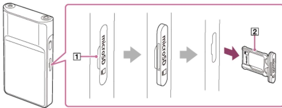
Coloque una tarjeta microSD en la bandeja de la tarjeta microSD (2) con la orientación correcta. Los pernos de contacto dorados deben estar orientados hacia el lado de la parte trasera del reproductor. Asegúrese de insertar la tarjeta microSD correctamente. De lo contrario, la tarjeta microSD se caerá cuando sostenga la bandeja (2) boca abajo. Inserte la bandeja (2) recta en la ranura de la tarjeta (3). Asegúrese de insertar la bandeja firmemente en la ranura, sin dejar espacios.
