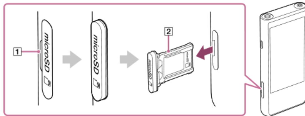
按正确方向将microSD卡放入microSD卡托（②）。
