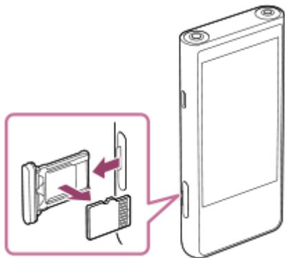
5. 将卡托径直插入卡槽。
