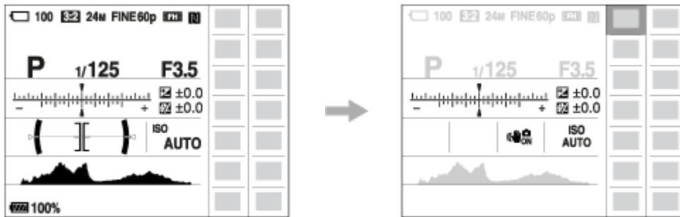
4. Wählen Sie die gewünschte Funktion aus, indem Sie die obere/untere/linke/rechte Position des Einstellrads drücken.
