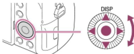
Puede seleccionar elementos de ajuste girando o pulsando el lado superior/inferior/derecho/izquierdo de la rueda de control. Su selección quedará determinada cuando pulse ● del centro de la rueda de control.
