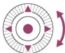
3. Seleccione el elemento de ajuste deseado pulsando el lado superior/inferior/izquierdo/derecho de la rueda de control o girando la rueda de control, y después pulse ● del centro de la rueda de control.
