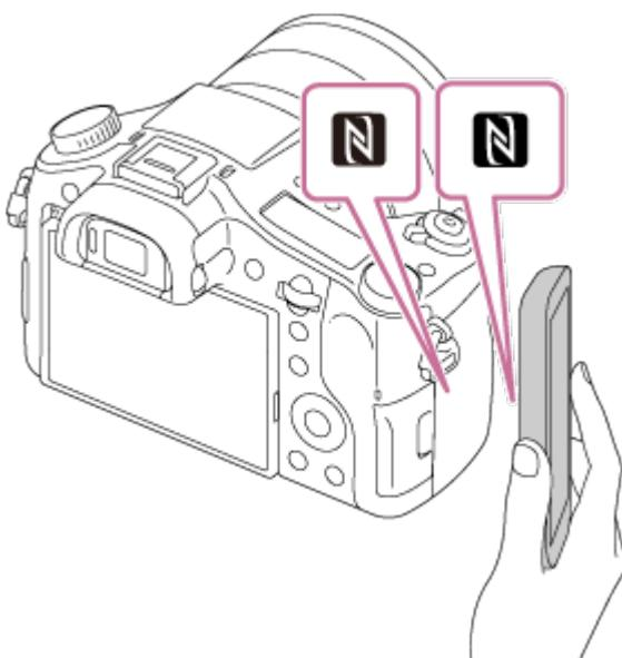
El producto y el smartphone se conectan, y PlayMemories Mobile se inicia automáticamente en el smartphone, y después la imagen visualizada se envía al smartphone.
