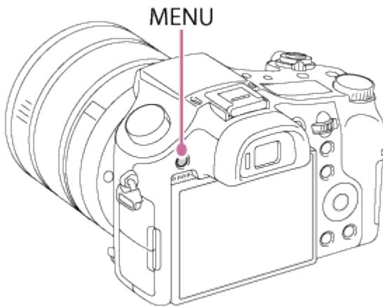
2. Sélectionnez l'élément de MENU souhaité en appuyant sur le côté supérieur/inférieur/gauche/droit de la molette de commande ou en la faisant tourner, puis appuyez sur ● au centre de la molette de commande.
