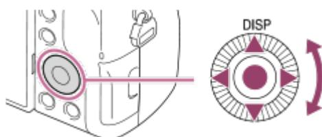
Vous pouvez sélectionner les éléments de réglage en tournant la molette de commande, ou en appuyant sur son côté supérieur/inférieur/droit/gauche. Validez votre sélection en appuyant sur ● au centre de la molette de commande.
