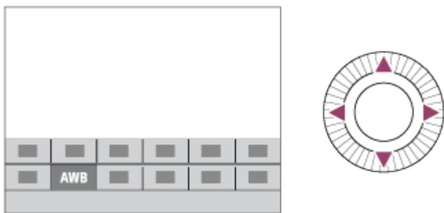
3. Sélectionnez le réglage souhaité en tournant la molette de commande, puis appuyez sur ● au centre de la molette de commande.
