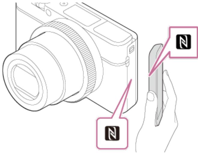
Le produit et le smartphone sont connectés, et PlayMemories Mobile est automatiquement lancé sur le smartphone, puis l'image affichée est envoyée vers le smartphone.
