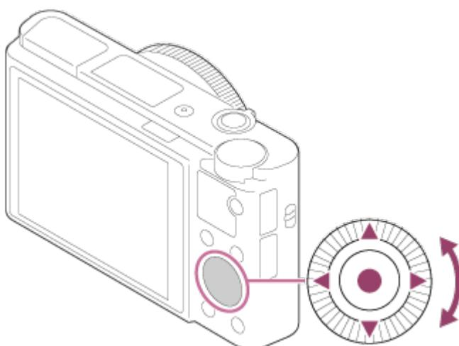
Vous pouvez sélectionner les éléments de réglage en tournant la molette de commande, ou en appuyant sur son côté supérieur/inférieur/droit/gauche. Validez
