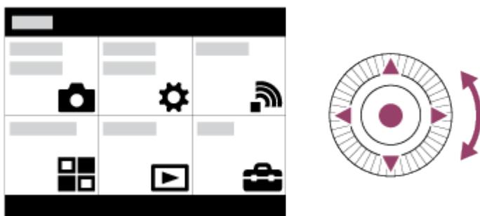
3. Sélectionnez l'élément de réglage souhaité en appuyant sur le côté supérieur/inférieur/gauche/droit de la molette de commande ou en la faisant tourner, puis appuyez sur ● au centre de la molette de commande.
