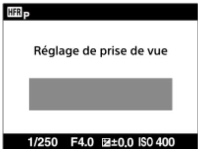
**2 MENU → **2** (Réglages de prise de vue2) → [ **HFR** Réglages HFR] puis sélectionnez les réglages souhaités pour [ **HFR** Réglage d'enreg.], [ **HFR** Vit. de défilement], [ **HFR** Réglage priorité] et [ **HFR** Chrono ENREG.].**
