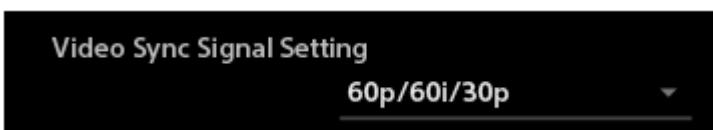
您可以設定用來同步已連接相機的視訊同步訊號。根據相機上的動態影像錄製設定，選取畫面更新率。
