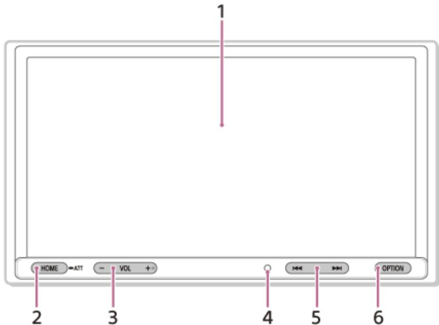
An der Taste VOL (Lautstärke) + befindet sich ein fühlbarer Punkt.
