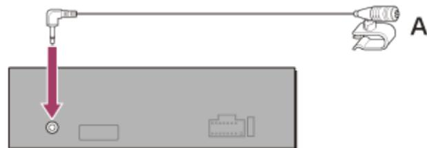
Инсталиране на свързания микрофон в автомобила Ви.
