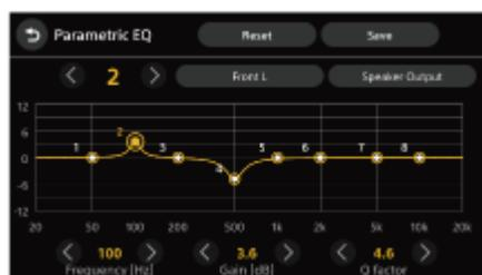
Puede activar o desactivar la salida de cada altavoz al comprobar el efecto de ajuste. Cuando no necesite el efecto de [EQ paramétrica], toque [Restabl.] para que todos los canales sean planos, guarde en [Personal. 1] o [Personal. 2], y selecciónelo.
