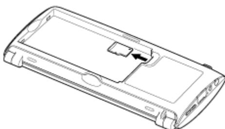
6. Halten Sie die microSD-Speicherplatte, und ziehen Sie sie aus dem Steckplatz heraus.
