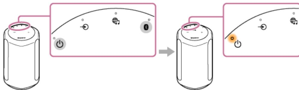
Si opera un dispositivo de red o un dispositivo BLUETOOTH para conectarse al altavoz, el altavoz se encenderá automáticamente y se iniciará la conexión.
