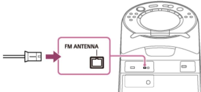
Растяните antennu (наружную) горизонтально. Держите antennu (наружную) подальше от шнура питания переменного тока (сетевого шнура) и кабеля USB, чтобы избежать возникновения помех.
