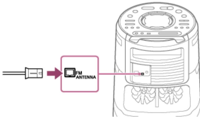
Растяните antennу (наружную) горизонтально. Держите antennу (наружную) подальше от шнура питания переменного тока (сетевого шнура) и кабеля USB, чтобы избежать возникновения помех.
