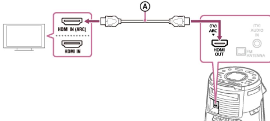
Ⓐ : Высокоскоростной кабель HDMI с Ethernet (не прилагается)
