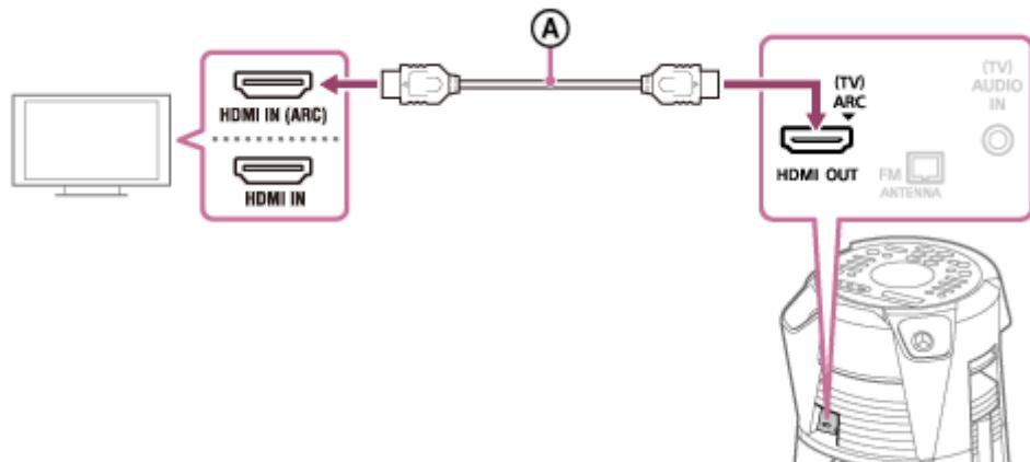
Ⓐ : Cabo HDMI de alta velocidade com Ethernet (não fornecido)
