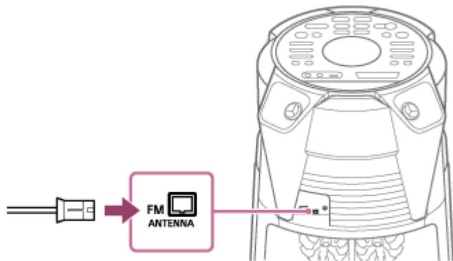
Estenda a antena (área) na horizontal. Mantenha a antena (área) afastada do cabo de alimentação de CA e do cabo USB para evitar captar ruído.
