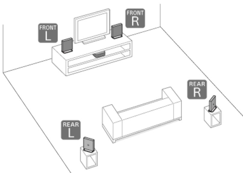
Compruebe la etiqueta de la parte inferior del altavoz para asegurarse de que coincide con la posición de instalación del altavoz.
