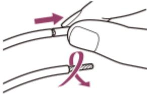
**4** AM外部アンテナ接続端子のレバーを押しながらアンテナコードを接続する。
