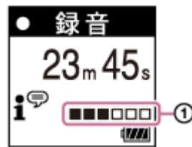
図のように、録音中の入力レベルの ■ が3～4個になるように、内蔵マイクの方向や音源からの距離を調節したり、内蔵マイクの感度を設定したりして、音源に合った適切な範囲に調節してください。マイク感度の設定方法については「マイク感度を設定する（内蔵マイク感度設定）」をご覧ください。
