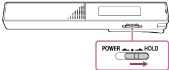
當IC錄音機開啟時，將POWER · HOLD開關滑向[HOLD]會在顯示視窗上顯示[HOLD]及目前時間大約3秒，表示IC錄音機的所有按鈕已停用。
