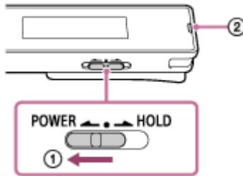
在您進行[疑難排除]主題所列的修正方法後，若問題仍持續發生，則可以透過重新啟動IC錄音機來解決問題。將POWER · HOLD開關滑向[POWER]並按住8秒以上（①）。顯示視窗關閉時，重新啟動程序會隨即開始。解除POWER · HOLD開關。如果在IC錄音機運作時重新啟動，IC錄音機中儲存的資料或IC錄音機設定可能被刪除。重新啟動之前，確認操作指示燈（②）不亮。
