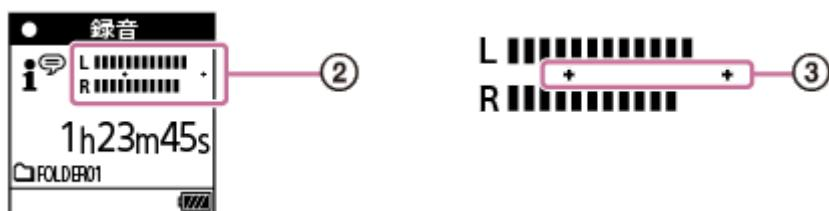
下図のように、録音中の録音レベルが、+と+の間に収まるように、内蔵マイクの方向や音源からの距離を調節したり、録音を停止してから内蔵マイク感度の設定、シーンセレクトの設定を変更してください。
