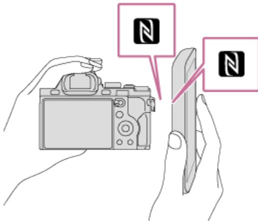
Le produit et le smartphone sont connectés, et PlayMemories Mobile est automatiquement lancé sur le smartphone, puis l'image affichée est envoyée vers le smartphone.
