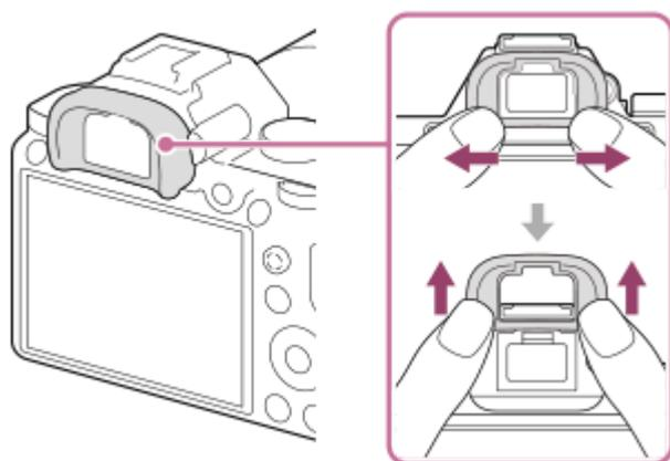
Retirez l'oculaire de visée lorsque vous fixez un viseur en angle (vendu séparément). De plus, sélectionnez MENU → 2 (Réglages de prise de vue2) → [FINDER/MONITOR], puis basculez sur [Viseur(manuel)] ou [Écran(manuel)].
