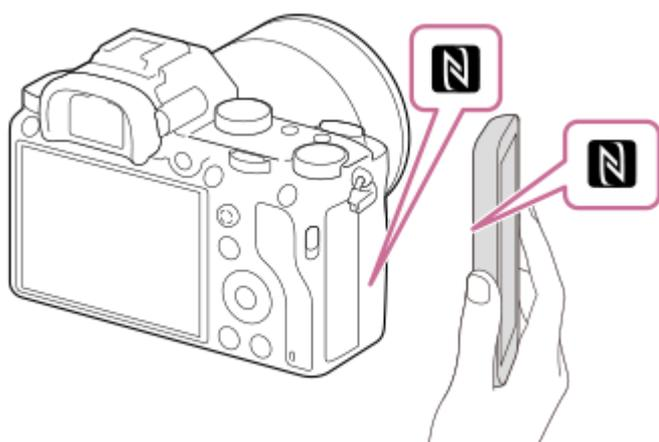
Le produit et le smartphone sont connectés, et PlayMemories Mobile est automatiquement lancé sur le smartphone, puis l'image affichée est envoyée vers le smartphone.
