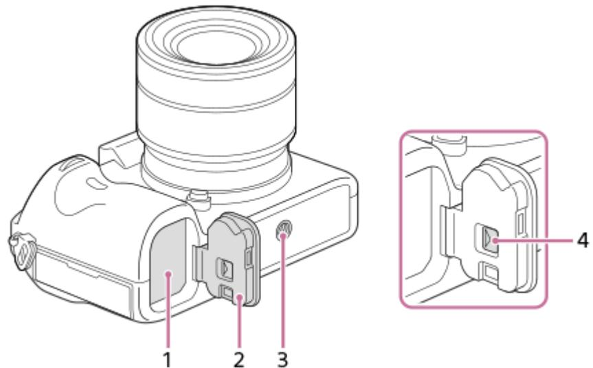
1. Slot di inserimento della batteria
