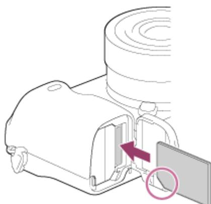
● 將缺角朝向圖解所示方向，將記憶卡插入直到卡入定位為止。正確插入記憶卡。否則可能造成故障。
