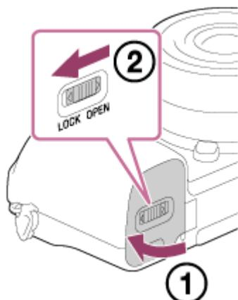
確認存取指示燈沒有發亮，並關閉相機電源。然後，滑動鎖定桿 (A) 並取出電池。小心不要讓電池掉落。
