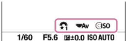
**2.** Gire la rueda de control para ajustar el valor ISO y gire el dial de control para ajustar el valor de abertura.
