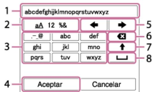
Sitúe el cursor sobre la tecla deseada utilizando la rueda de control, después pulse el centro para introducir.
