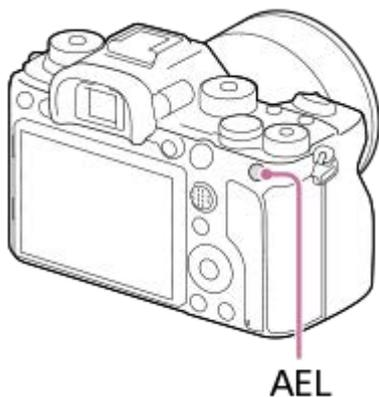
露出が固定され、\* (AEロックマーク) が表示される。
