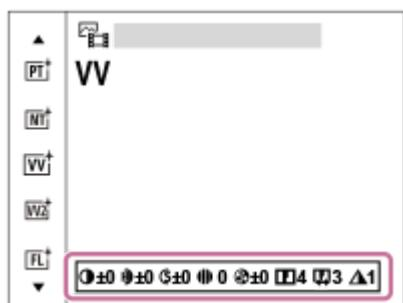
**4** 當選取 [ 自訂外觀 ] 時，使用控制滾輪的右側，移動至右邊，然後選擇要使用的“外觀”。
