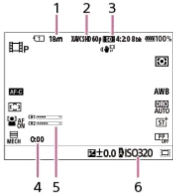
1. 目前顯示的插槽的可錄製動態影像時間
