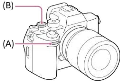
您也可以使用 [ 我的轉盤設定 ] 功能，將您要使用的功能指派給前轉盤 / 後轉盤，並在需要時叫出那些功能。
