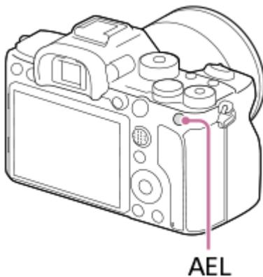
Die Belichtung wird gespeichert, und **\*** (AE-Speicher) wird angezeigt.
