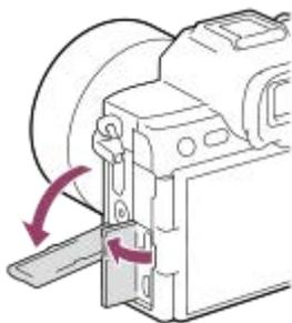
2. Inserire il gancio (A) della protezione cavi nella tacca (B) sotto il terminale USB multiplo/Micro e fissarlo in modo che copra la superficie del terminale della fotocamera mantenendo premuto per impedire che si stacchi.
