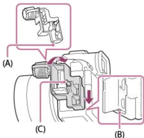
3. Spingere verso l'interno la vite di fissaggio (C) e ruotarla per bloccare in posizione la protezione cavi.
