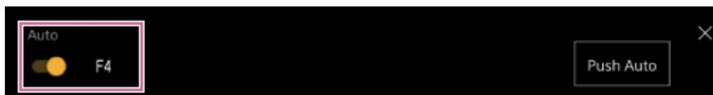
Le diaphragme passe en mode de réglage automatique. La valeur de réglage automatique du diaphragme s'affiche sur le côté droit du commutateur.
