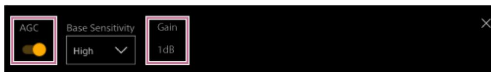
Le gain commute sur le mode de réglage automatique. La valeur du gain ajusté automatiquement s'affiche sur le côté droit du commutateur.
