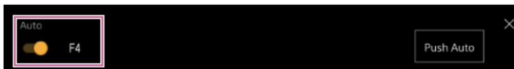
A íris passa para o modo de ajuste automático. O valor de ajuste automático da íris é apresentado no lado direito do interruptor.
