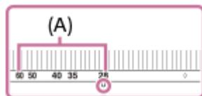
在进行拍摄时，转动变焦环直到焦距标记进入焦距刻度范围 (A) 以伸长镜头。
