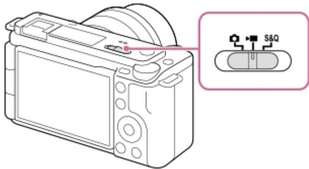
使用静止影像/动态影像/S&Q开关可选择静止影像照相模式、动态影像拍摄模式或慢动作/快动作录制模式等照相模式。
