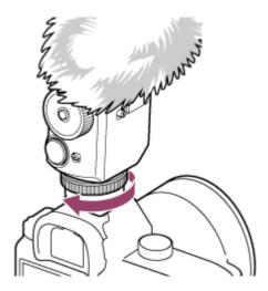
A fixação desta unidade numa câmara muda automaticamente a entrada de áudio do microfone incorporado para o microfone externo.
