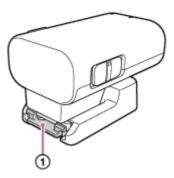
Richten Sie den Multi-Interface-Fuß des Empfängers mit dem Multi-Interface-Schuh an der Kamera aus und bringen Sie den Empfänger an.
