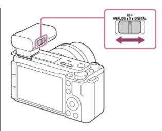
如果您的相机与多接口热靴的数字音频接口兼容,请确保此开关设置为"DIGITAL"。否则,请将此开关设置为"ANALOG"。
