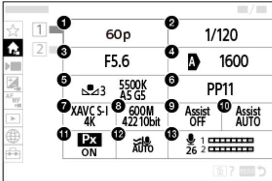
1. 記録フレームレート / **S&Q** フレームレート設定（スロー&クイックモーション撮影時） /
