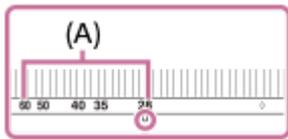
撮影するときは、ズームリングを回して、焦点距離目盛の範囲 (A) が焦点距離指標に合うまでレンズを繰り出してください。
