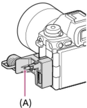
3. Enfoncez la vis de fixation (A) et tournez-la pour bloquer le protège-câble.
