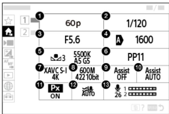
1. Vit. défilem. enr./ **S&Q** Régl. vit. défilem. (lors de l'enregistrement de films au ralenti/en accéléré)/ **Q** Régl. vit. défilem. (lors de l'enregistrement Time-lapse)
