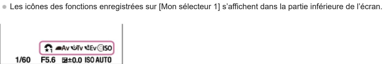
2. Tournez la molette de commande pour régler la valeur ISO, tournez le sélecteur avant pour régler la valeur d'ouverture, tournez le sélecteur arrière L pour régler la vitesse d'obturation et tournez le sélecteur arrière R pour régler la correction d'exposition.
