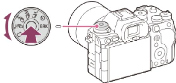
Tournez le sélecteur de mode d'entraînement tout en maintenant enfoncé le bouton de déverrouillage du sélecteur de mode d'entraînement au centre pour sélectionner le mode souhaité.
