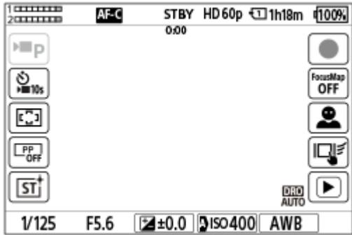
Icônes sur le côté gauche : Mode Pr. vue, Retardateur, Zone mise au pt, Profil d'image, Apparence créat.
