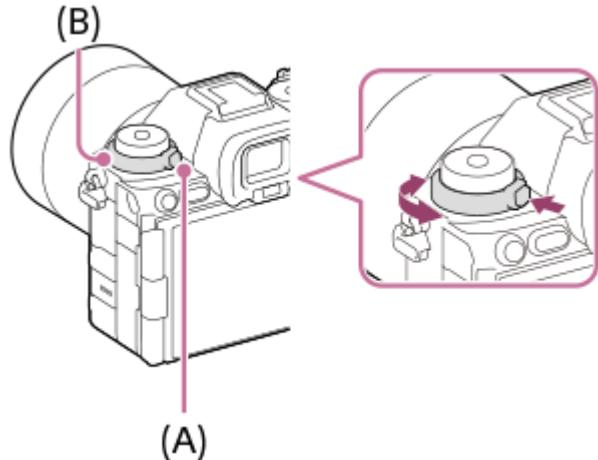
Tournez le sélecteur de mode de mise au point (B) tout en maintenant enfoncé le bouton de déverrouillage du sélecteur de mode de mise au point (A) pour sélectionner le mode souhaité.
