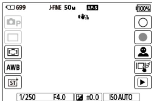
Icônes sur le côté gauche : Mode Pr. vue, Entraînement, Zone mise au pt, Bal. des blancs, Apparence créat.
