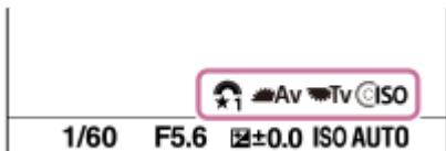
2. 转动控制拨轮设定ISO值，转动前转盘设定光圈值，并转动后转盘设定快门速度。
