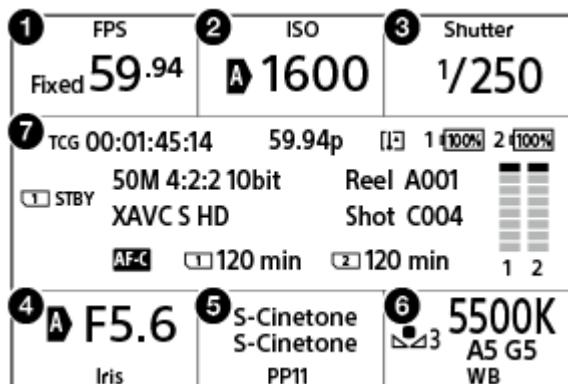
用于录制动态影像的设置值显示在区域1-6。触摸各项目即可跳转至该项目的设置画面。
