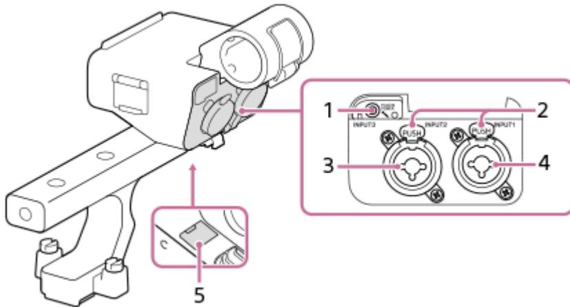
1. INPUT3插孔 (立体声迷你插孔, 兼容插入式电源)
