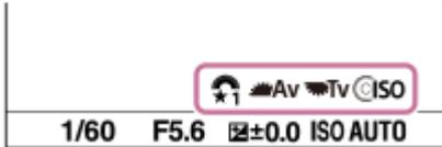
2. 轉動控制滾輪可設定ISO值，轉動前轉盤可設定光圈值，轉動後轉盤則可設定快門速度。
