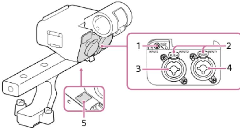
1. INPUT3插孔 ( 立體聲迷你插孔，可相容插入供電 )
