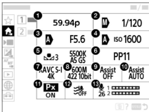
1. 錄製幀率/ **S&Q** 錄製幀率 ( 拍攝慢動作/快動作動態影像時 )
