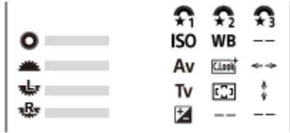
範例：具備前轉盤、後轉盤L、後轉盤R的機型的 [ 我的轉盤設定 ] 畫面
