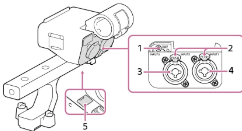
1. Presa INPUT3 (minipresa stereo, compatibile con alimentazione plug-in)
