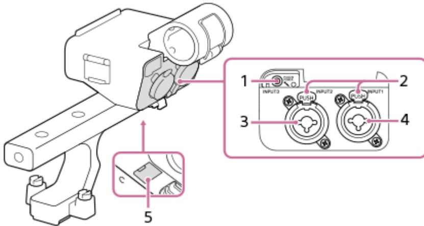
1. INPUT3插孔 (立体声迷你插孔, 兼容插入式电源)
