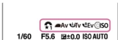
2. Gire la rueda de control para ajustar el valor ISO, gire el dial frontal para ajustar el valor de abertura, gire el dial trasero L para ajustar el tiempo de exposición y gire el dial trasero R para ajustar la compensación de exposición.
