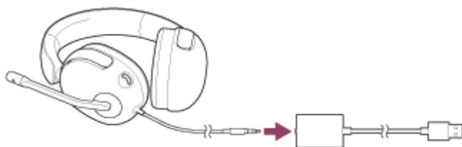
2. 将USB音频盒连接到电脑的USB端口。
