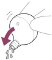
3. Dé la vuelta a la parte del micrófono o del orificio de ventilación y aplíquelo unos 20 toques suaves con un paño seco, etc. para expulsar el agua acumulada en su interior.
