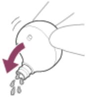
3. Dé la vuelta a la parte del micrófono o del orificio de ventilación y aplíquelo unos 20 toques suaves con un paño seco, etc. para expulsar el agua acumulada en su interior.
