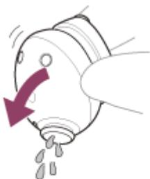
3. Vire a parte do microfone ou do orifício de ar para baixo e bata cuidadosamente cerca de 20 vezes sobre um pano seco ou algo semelhante para retirar a água acumulada no interior.
