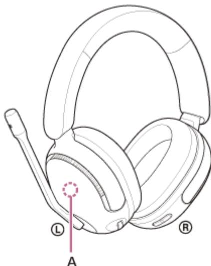
A: Integrierte Antenne
