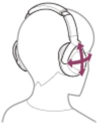
Wenn Sie das Headset aufsetzen, ohne den Schieber zu verstellen, wird das Headset auf dem Kopf möglicherweise nicht richtig positioniert, sodass es nicht komfortabel sitzt oder der Rauschunterdrückungseffekt nur schwach ist.
