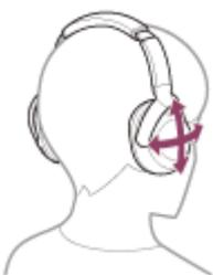
如果您在未調整滑動器的情況下戴上耳機，耳機可能無法在您的頭部正確定位，從而導致不適感或降噪效果不佳。耳機的配戴偵測功能也可能無法正常運作，導致音樂播放自動停止或啟動自動電源關閉功能（電池電力節省功能），從而自動關閉耳機。
